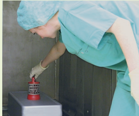
Abb. 4: Der EBI 16 kann eine umfassende Routinekontrolle von Dampfsterilisatoren mittels elektronischem Bowie-Dick-Test gemäß EN 285/DIN EN ISO 17665 durchführen.
