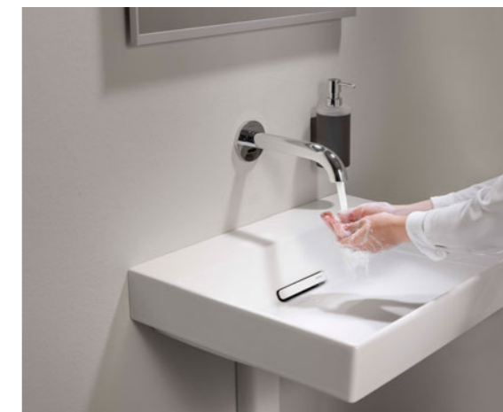
Abb. 2: Die Platzierung des Abflufs am hinteren Beckenrand minimiert das Rückspritzen von keimbelastetem Wasser aus dem Abwassersystem. Foto: Geberit
