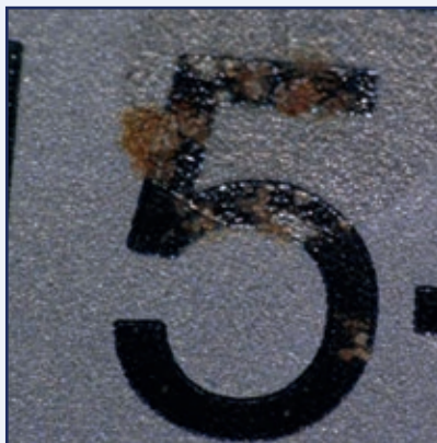
Abb. 5: Ursache: Überalterung des Farb-codierungsbandes lässt Unterwanderung schädlicher, chloridhaltiger Substanzen zu.
