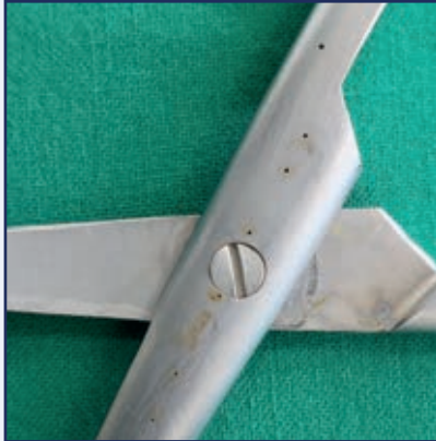
Abb. 1: Schere mit Lochkorrosion.
