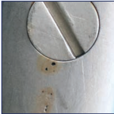
Abb. 3: Schere mit Lochkorrosion.
