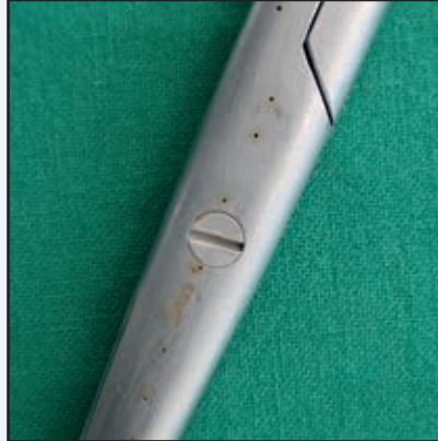
Abb. 2: Schere mit Lochkorrosion.
